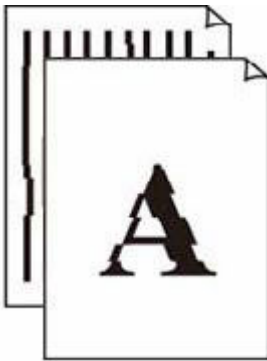
Les lignes sont mal alignées/déformées
